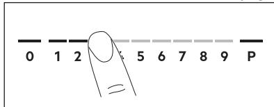
Als eenmaal een pan op de zone zet en de kookstand instelt, blijft deze gedurende 2 minuten gelijk nadat u de pan heeft verwijderd. De regelbalk en de aanduiding van de kookzone knipperen gedurende 2 minuten. Als u de pan binnen deze tijd weer op de kookzone plaatst reageert de kookstand. Zo niet, wordt de kookzone gedeactiveerd.
