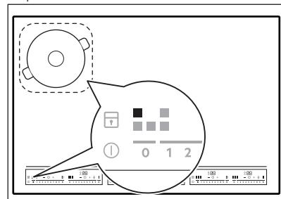
Jedes Quadrat auf dem Bedienfeld kennzeichnet eine Kochzone auf der Induktionskochfläche. Die Zonenanzeigen zeigen an, welche
